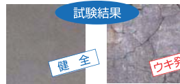
試験結果 健全 ウキ発生 モルヒット・エコ厚塗用 1:3モルタル
