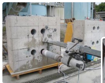
ハイパーネット70Lと60を取り付けた壁にコンクリートを打設し、コア抜きを行った。
