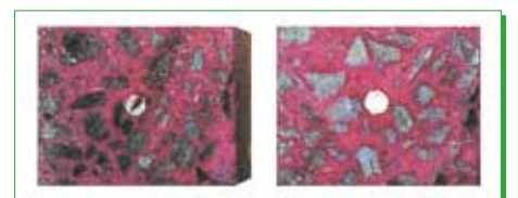
写真-3 太平洋スーパーミックスを用いたPC供試体の断面
