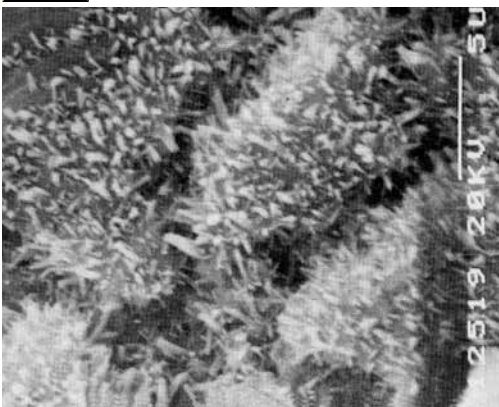
写真-1 コンクリート破断面の電子顕微鏡観察
