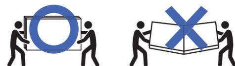
パネル運搬時は、板面を垂直にして、お持ちください。板面を水平にして持ち運ぶと、たわみなどで製品が折損する恐れがあります。
